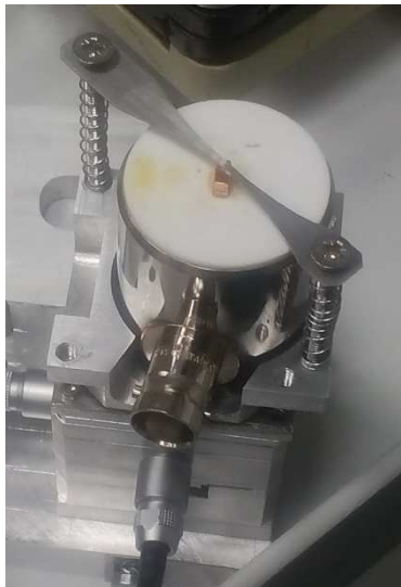
16. ábra: Akusztikus detektor egy hozzáerősített Cu mintával
